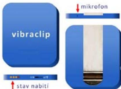
ku v okolí, 3x zavibruje a neslyšící na tento podnět adekvátně zareaguje. Vibraclip je krabička 60x60x15 milimetrů, s dobíjením přes mikroUSB (jako mobilní telefon), s klipem, která se připeňuje na oblečení (nejlépe tam, kde se oblečení dotýká těla – triko, košile, šála, čepice, atd.)
